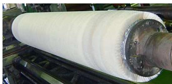
ブラシ材を U 型チャンネルの左右口縁部から延ばした爪の間にブラシ束を連続挿入し、左右両側の爪片を内側斜めに交叉させ、芯材がブラシ材を押さえスパイラル状に圧縮巻きつけ、完成します。
