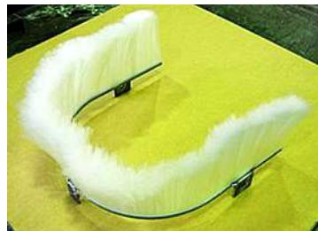
この SK 型カップブラシは機械装置の中に取り付けて、作業中に飛び散る粉塵が飛散するのを防止するカバーの役目をするために作られたブラシです。機械に取り付けるためにプレートを溶接加工しています。ブラシの毛先を床面に向けて取付けます。
